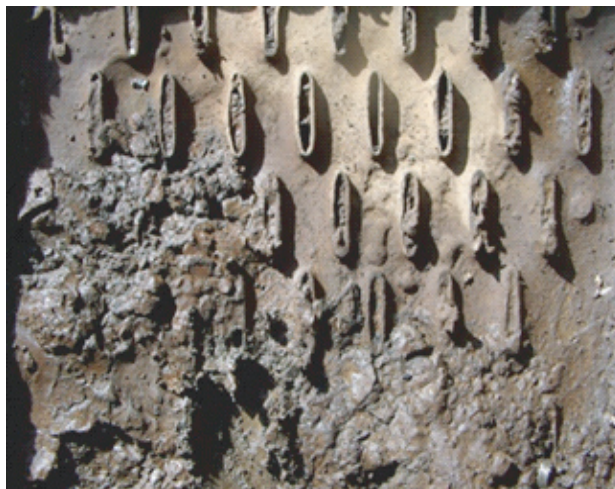
Рис. 1. Состояние системы водоохлаждения дизелей тепловозов
