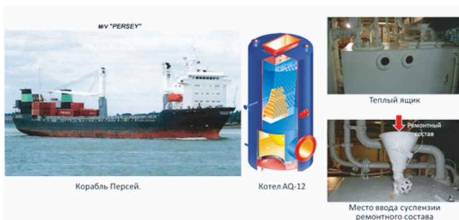
Рис. 8. Обработка ЭМВ водяного тракта котельной корабля Персей №821439 (26.05.2014 года)
