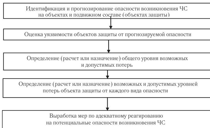
Рис. 4. Алгоритм оценки уязвимости объектов и подвижного состава ОАО «РЖД» от ЧС [6]
