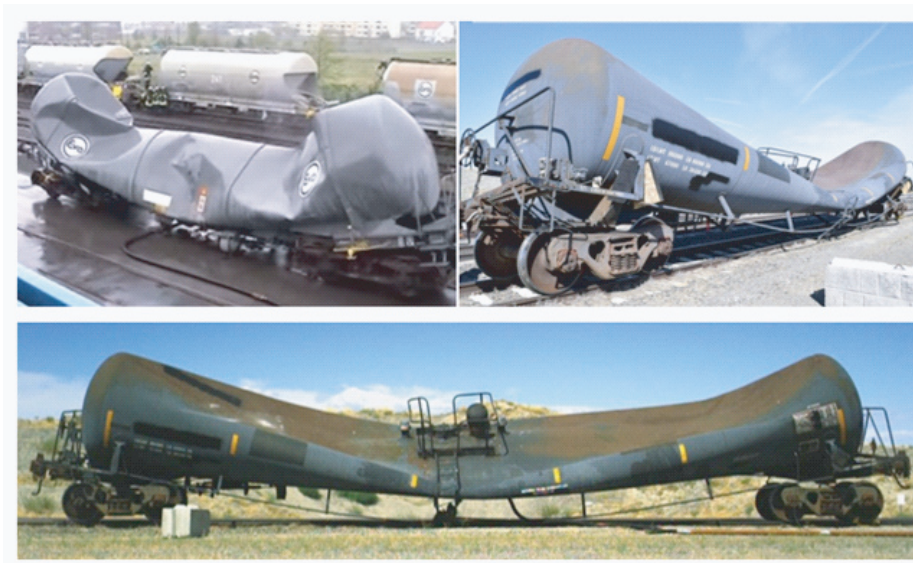
Рис. 1. Последствия потери устойчивости котла цистерны
