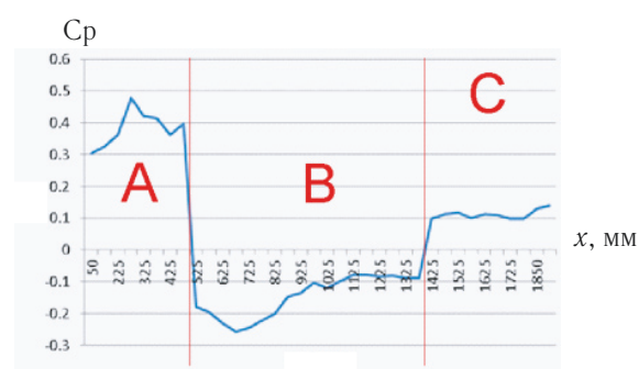
Рис. 6. Распределение коэффициента лобового сопротивления по длине шумозащитного экрана при 2-й расчетной ситуации в средних точках
