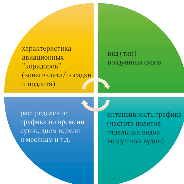
Рис. 7. Параметры для расчета уровня авиационного шума на территории жилой застройки
