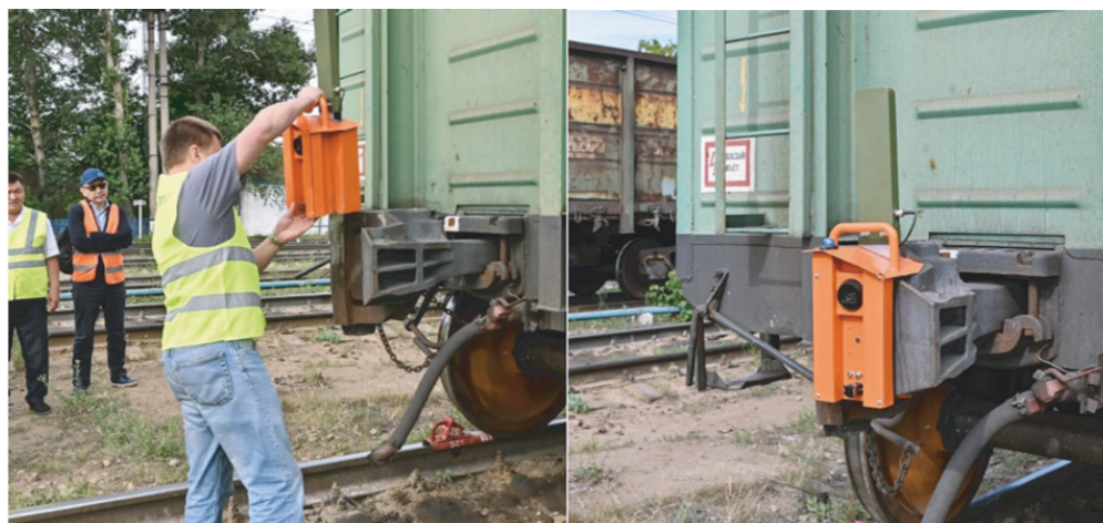
Рис. 5. Пример установки системы дистанционного видеоконтроля на хвостовой вагон (система CTRL@VISION 100WE) [16;17]
