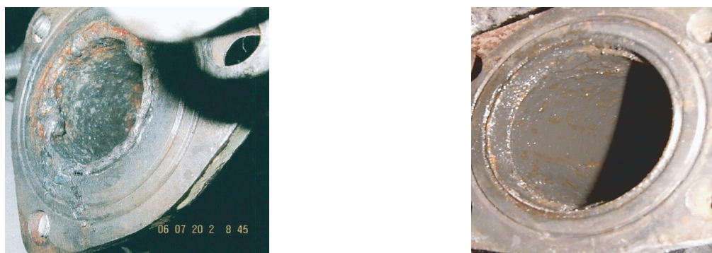
Рис. 12. Внешний вид трубопровода отопления вагона после химической очистки (слева) и после применения энергетического метода (справа)
