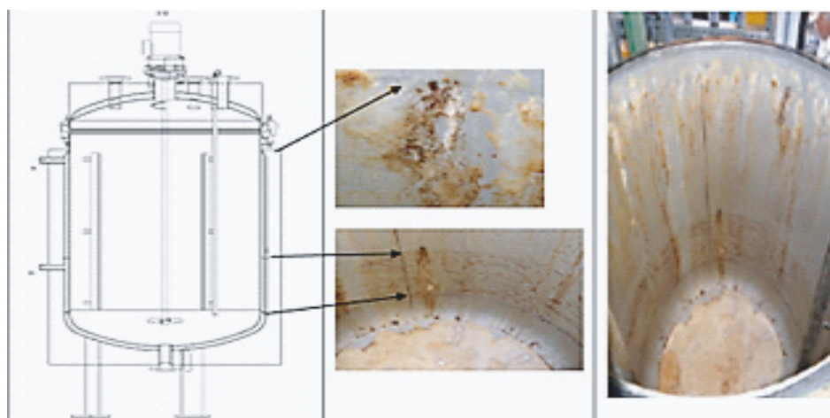
Рис. 11. Коррозионные разрушения систем водоохлаждения импортного оборудования (Германия), выполненного из нержавеющей стали из-за употребления воды низкого качества (псевдоустойчивой)
