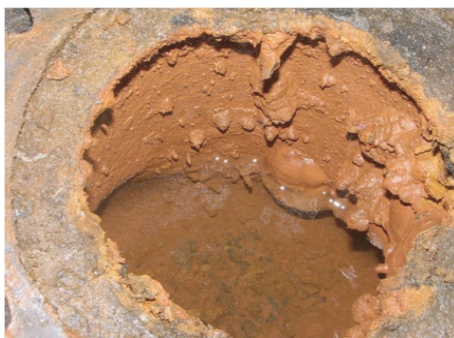
Рис. 9. Микробиологическая коррозия на сетях заправки вагонов водой и водопроводе пассажирского вагона
