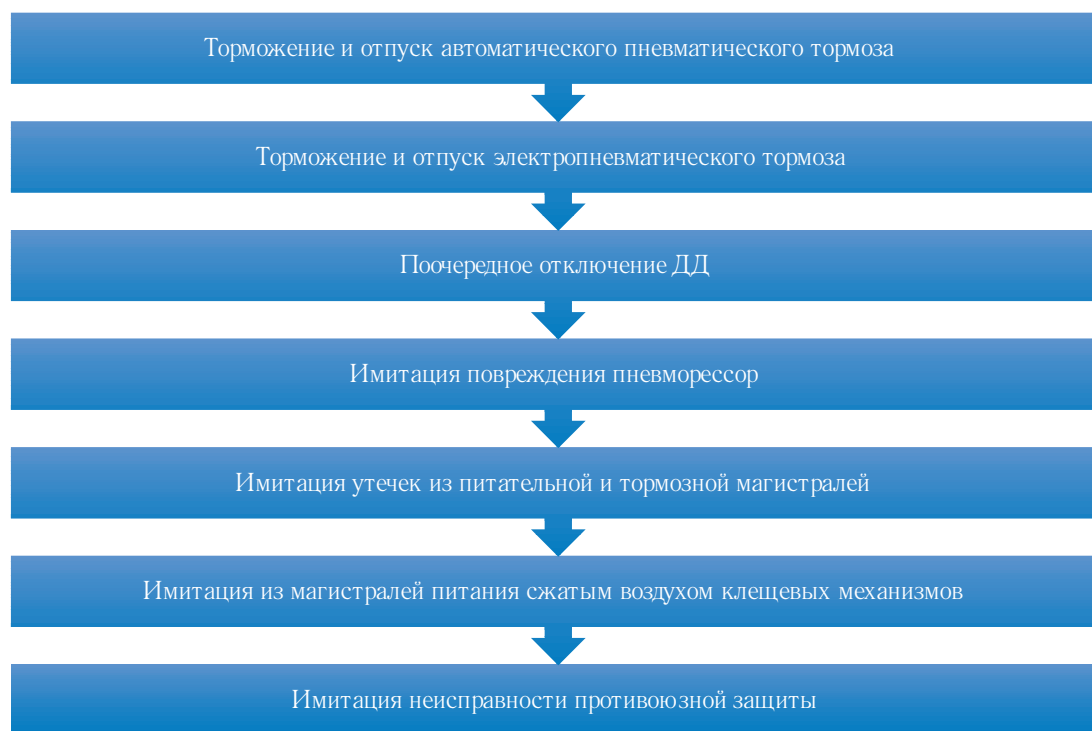
Рис. 8. Манипуляции и воздействия на элементы пневматической сети, необходимые при проведении испытаний
