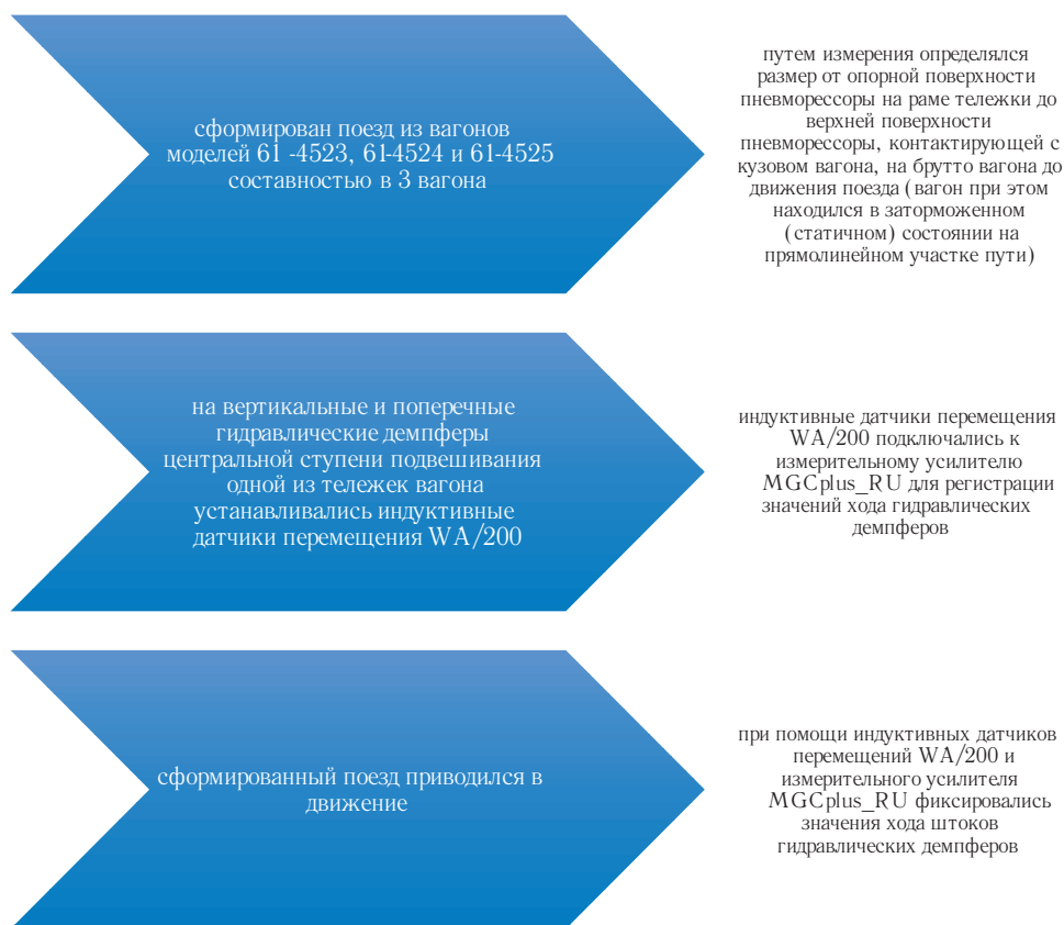
Рис. 5. Алгоритм испытания по показателю «Проверка поддержания на заданном уровне высоты пола вагона относительно рамы тележки»
