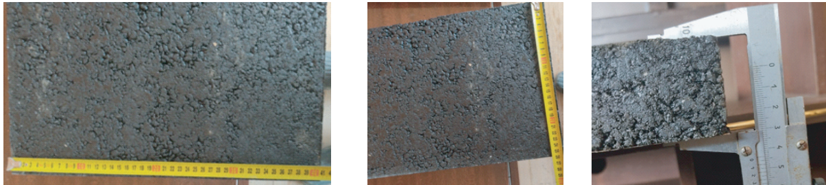
Рис. 3. Измерение геометрических параметров образцов
