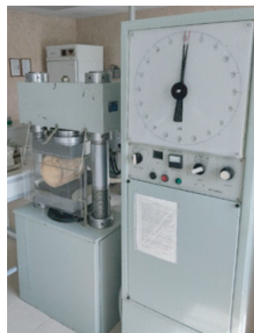
Рис. 7. Гидравлический пресс ИП-1000-0
