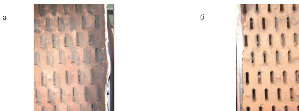
Рис. 4. Состояние секций холодильника до (а), после обработки и года эксплуатации (б)
