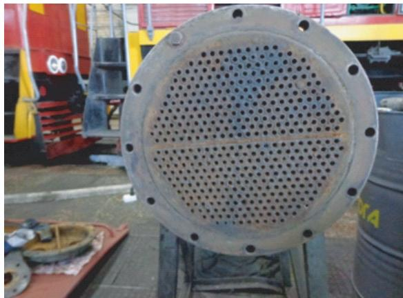
Рис. 10. Общий вид маслоохладителя после обработки, гидравлической промывки и механической очистки
