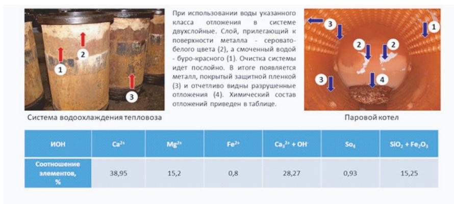
Рис. 12. Особенности очистки отложений системы водоохлаждения тепловоза (парового котла) при использовании воды кальций-гидрокарбонатного класса
