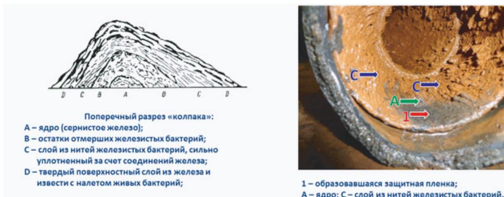
Рис. 5. Размытие «колпаков» микробиологической коррозии в результате применения ЭМВ
