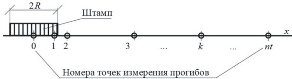
Рис. 2. Схема измерения прогибов от штампа
