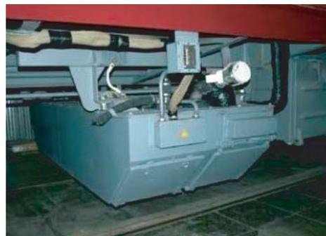
Рис. 1. Внешний вид экологически чистых туалетных комплексов с накопительными баками
