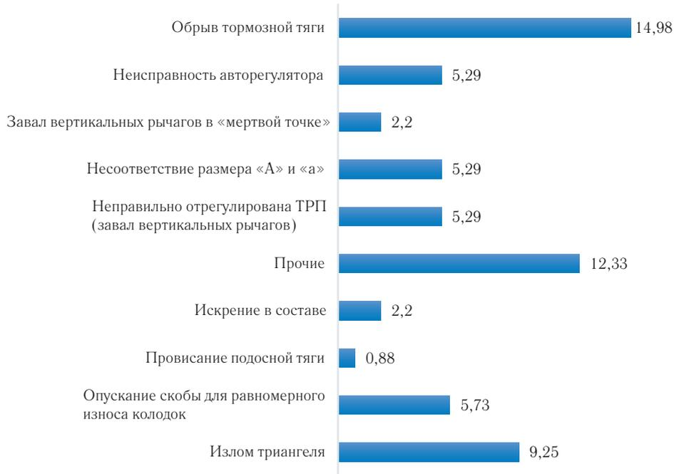
Рис. 1. Причины отказов тормозной рычажной передачи [3]
