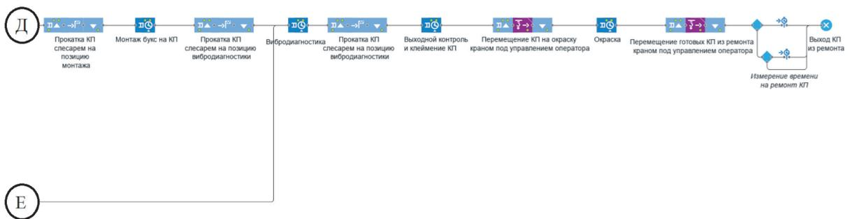
Рис. 5. Диаграмма процесса ремонта колесных пар (часть 3)
