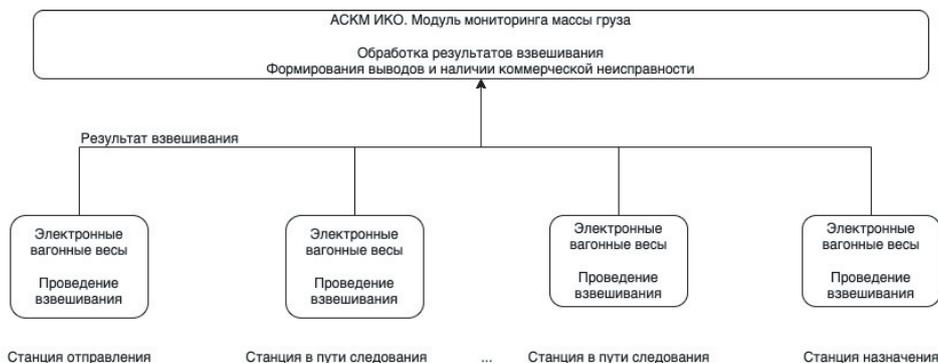
Рис. 2. Внутренние информационные потоки Модуля мониторинга массы груза
