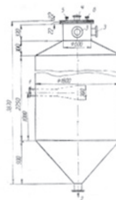
Рис. 3. Испаритель: 1- штуцер для подачи кубового остатка; 2 – штуцер для отвода охлажденного кубового остатка; 3 – штуцер для отвода паров вскипания; 4 – штуцер для установки предохранительного клапана; 5 – штуцер для присоединения мановакуумметра; 6 – штуцер для установки регулятора расхода
