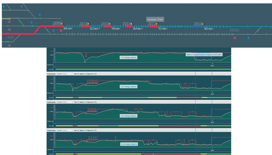
Рис. 6. Фрагмент выходных форм имитационного моделирования пропуска поездов при «АЛСО с ПБУ»
