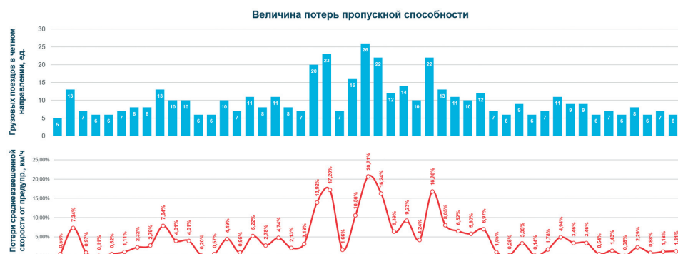
Рис. 1. Анализ потерь допустимой скорости движения грузовых поездов и их влияния на величину потерь пропускной способности
