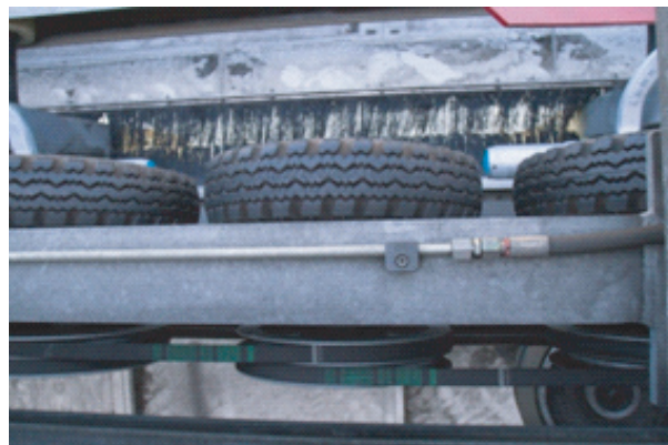
Рис. 3. Система разгона и торможения спредера
