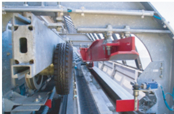
Рис. 3. Система разгона и торможения спредера
