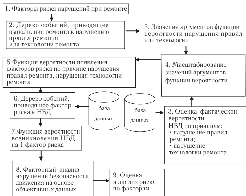
Рис. 4. Общая схема факторного анализа рисков при ремонте
