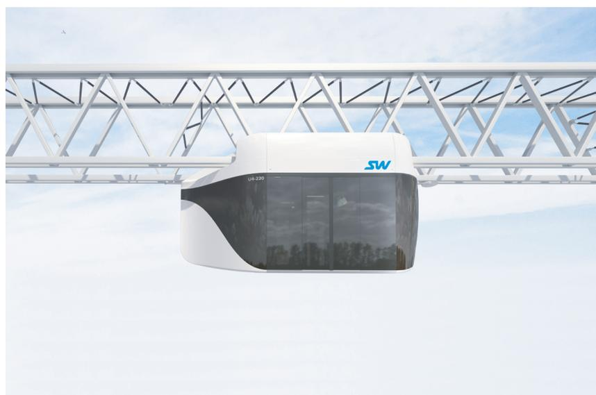
Рис. 4. Общий вид 14-ти местного подвесного бирельсового юнибуса
