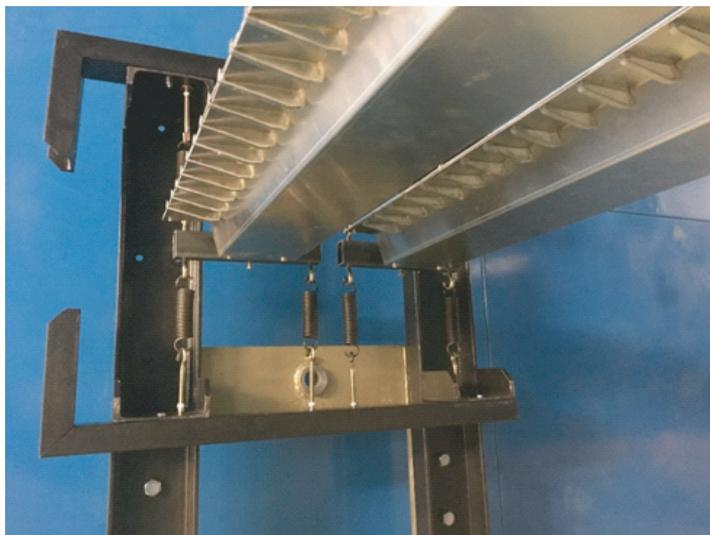
Рис. 2. Монтаж отсечной модели пролетного строения в специализированном стенде на пружинных подвесах на базе УНУ БИГАТ НИУ МГСУ
