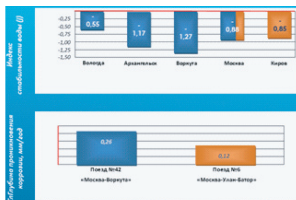
Рис. 4. Взаимосвязь коррозионной агрессивности воды в пунктах экипировки вагонов водой и скорости коррозии в системах водотеплоснабжения поездов Северного и Восточного направлений
