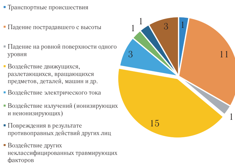
Рис. 5. Анализ несчастных случаев, произошедших с составителями поездов, по видам происшествий
