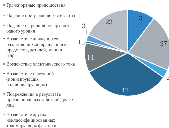
Рис. 6. Анализ несчастных случаев, произошедших с монтерами пути, по видам происшествий
