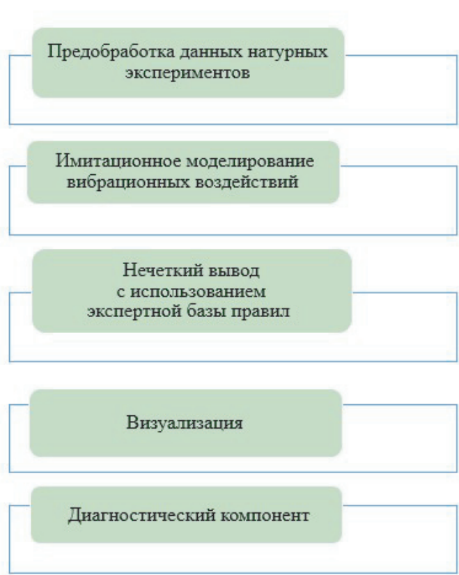
Рис. 3. Основные компоненты инструментально-методического обеспечения автоматизированной оценки вибрационных воздействий транспортных средств на инфраструктурные объекты
