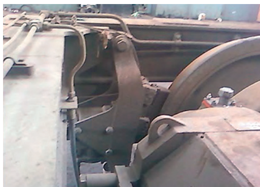
Рис. 2. Тормозная система локомотива: а – подвеска тормоза в сборе; б – крепление башмака с тормозной колодкой к подвеске
