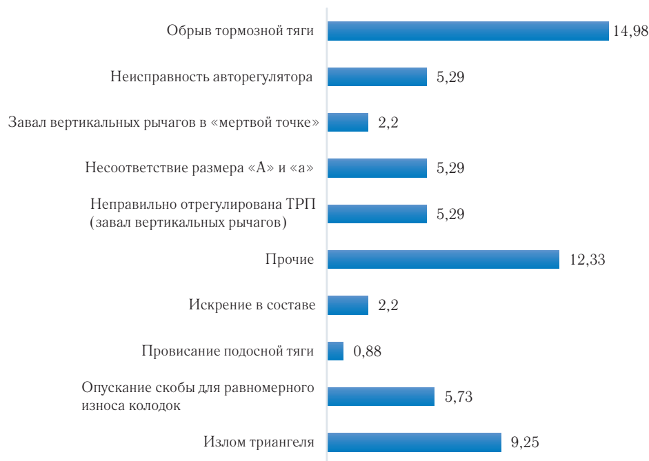
Рис. 1. Причины отказов тормозной рычажной передачи [3]
