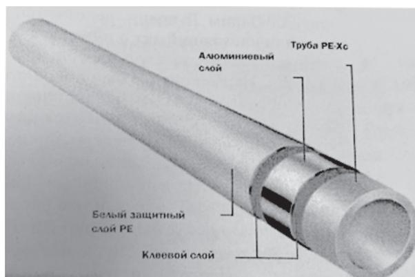
Рисунок. Схема слоев трубы напорной металлополимерной из сшитого полиэтилена с наружным барьерным слоем PE/Хс
