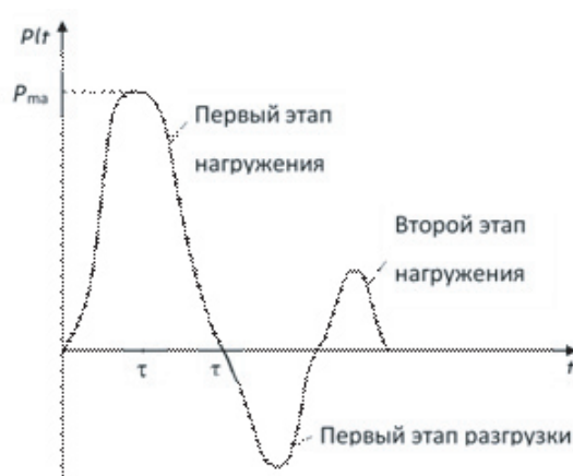
Рис. 4. Примерная зависимость изменения силы воздействия на путь от времени
