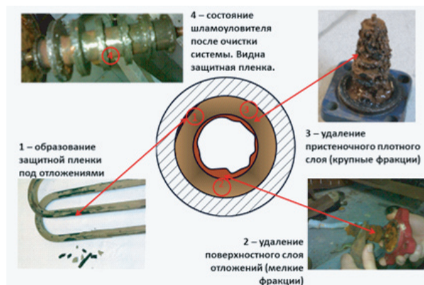
Рис. 7. Этапность технологического процесса обработки системы с толщиной отложений более 3 мм энергетическим методом
