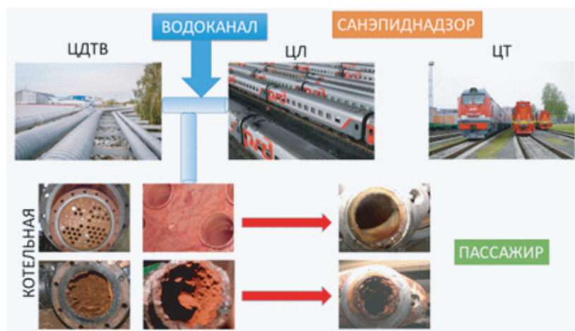
Рис. 1. Укрупненная схема движения воды от источника водоснабжения к потребителю для транспортного комплекса (столичный регион)
