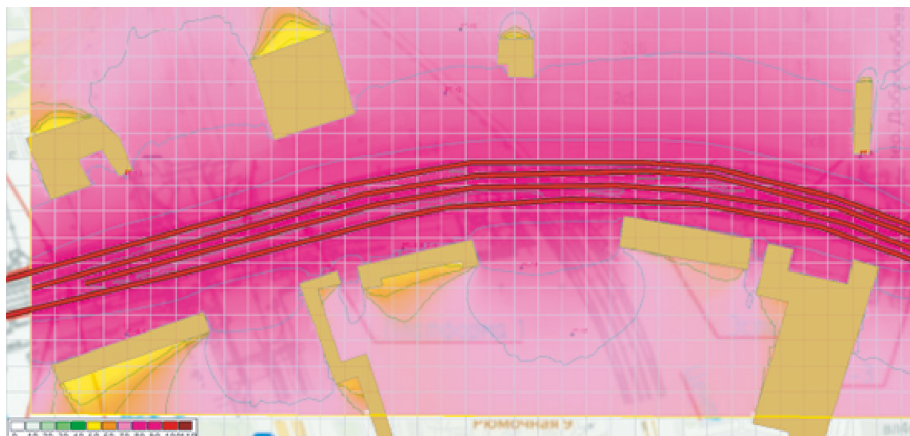
Рис. 3. Схема распределения изолиний без учета установки подбалластных матов (высота распределения изолиний 1,5 м, дневное время)
