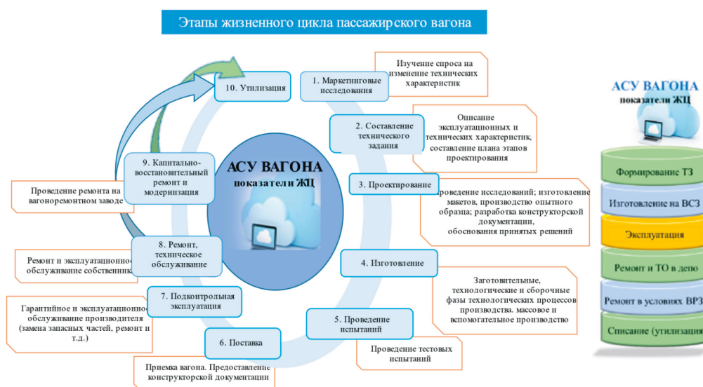
Рис. 2. Схема жизненного цикла пассажирского вагона и его «цифрового двойника»
