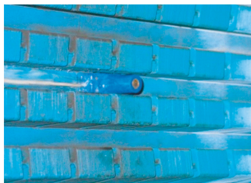
Рис. 4. Датчик для стационарной установки поля ротора
