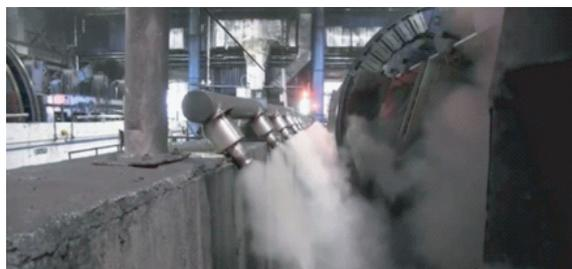
Рис. 4. Пылеподавление при разгрузке полувагона
