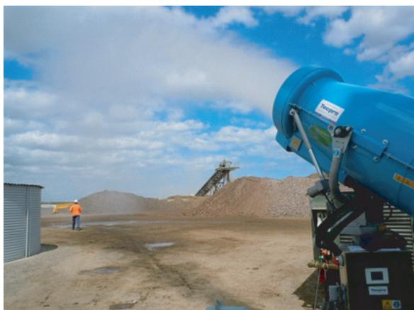
Рис. 1. Создание высоконапорных водяных завес
