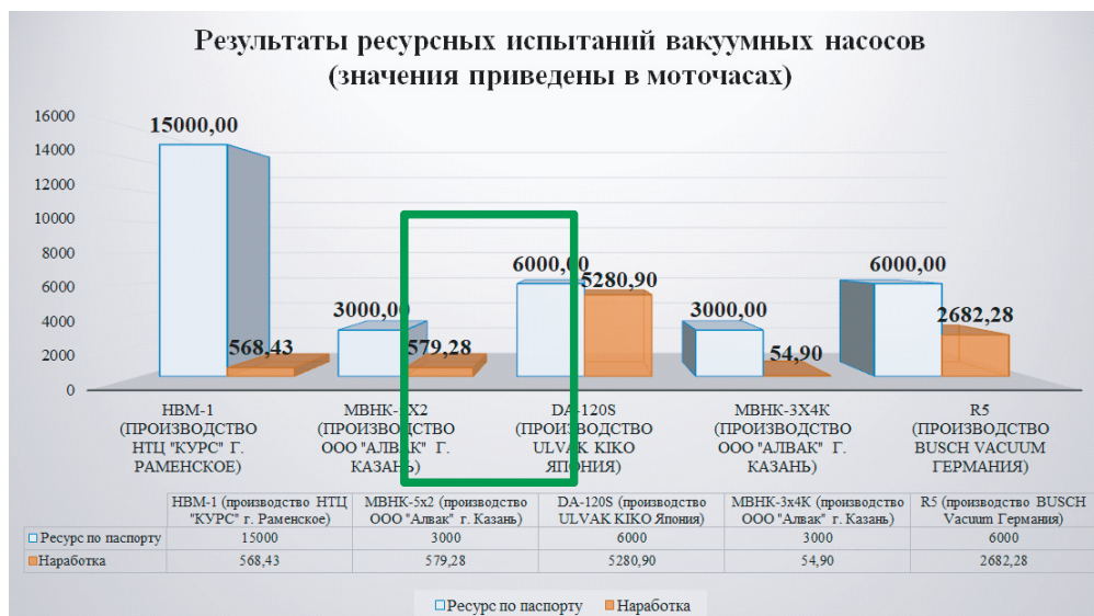
Рис. 3. Результаты ресурсных испытаний вакуумных насосов в моточасах
