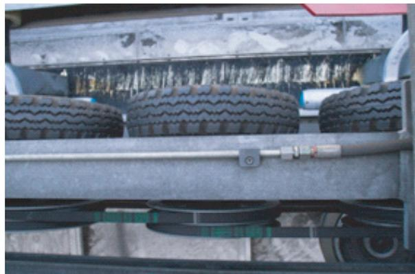
Рис. 3. Система разгона и торможения спредера
