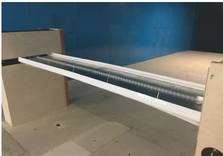
Рис. 1. Испытания отсечной модели пролетного строения в специализированном стенде на базе УНУ БИГАТ НИУ МГСУ
