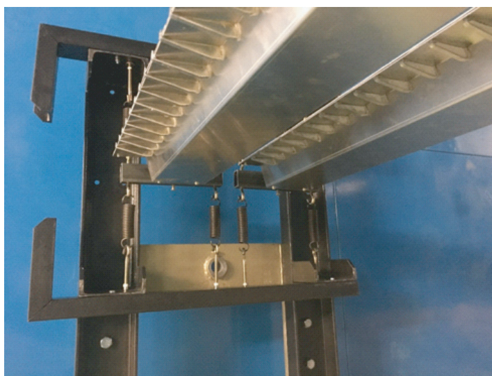
Рис. 2. Монтаж отсечной модели пролетного строения в специализированном стенде на пружинных подвесах на базе УНУ БИГАТ НИУ МГСУ
