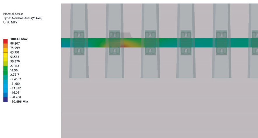
Рис. 5. Нормальные напряжения в рельсе при воздействии нагрузки от колеса 15 тонн и боковой силы 5 тонн (скрепления ЖБР-65ПШМ)
