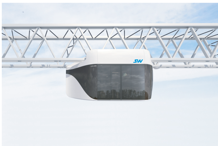
Рис. 4. Общий вид 14-ти местного подвесного бирельсового юнибуса
