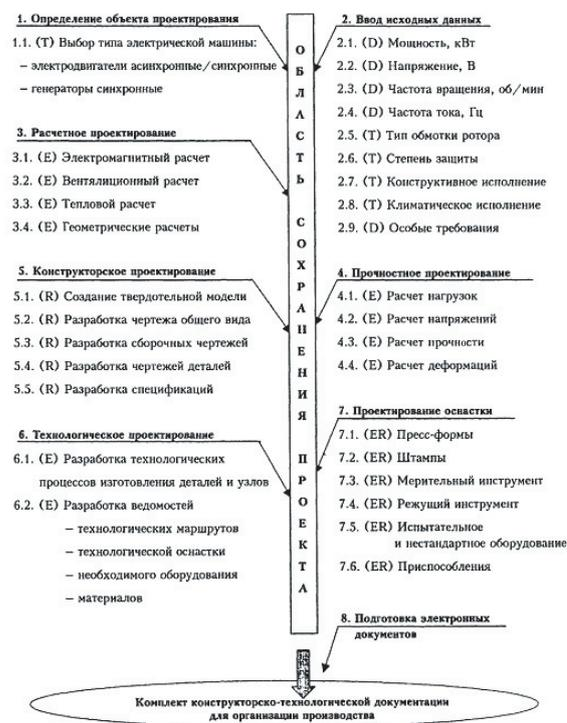
Рис. 2. Возможности пользователя при проектировании электрической машины на основе единого информационного пространства
