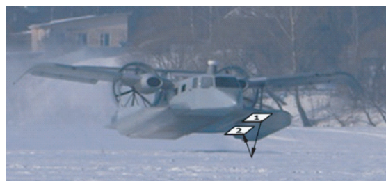
Рис. 4. Расположение УЗ передатчика и УЗ приемника на нижней поверхности ВСА:
