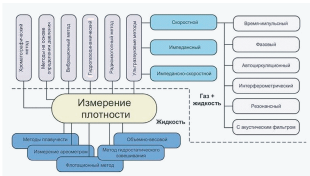
Рис. 1. Методы определения плотности жидкости и газа
