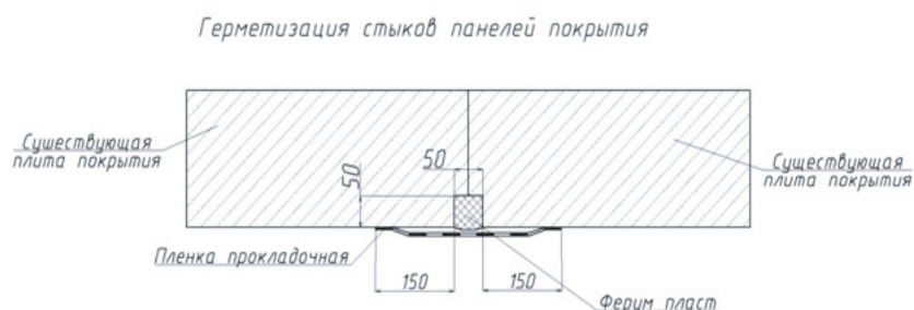
Рис. 10. Пример герметизации стыков железобетонных конструкций системой Ферум-Пласт
