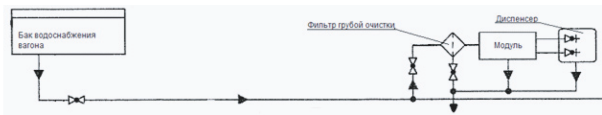
Рисунок. Гидравлическая схема питьевого водоснабжения вагона
