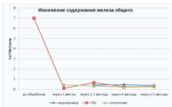
Рис. 5. Изменение содержания железа общего в результате применения ЭМВ
