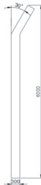
Рис. 1. Профиль шумозащитного экрана
