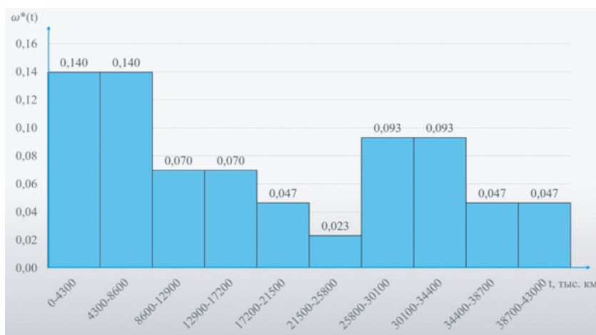
Рис. 7. Зависимость параметра потока отказов от пробега
